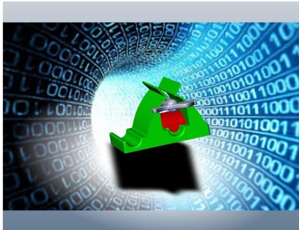
On aperçoit que le mécanisme comporte trois pièces (voir : pièces mises en jeux), le fonctionnement de se dernier se fait par le positionnement de la base du tube du dentifrice dans la rainure de l'aspirateur puis l'utilisateur effectue une rotation de se dernier, qui permet l'enroulement du tube dont sa surface extérieure vient en contact plan/plan avec le glisseur qui permet la compression du produit dans le tube.
